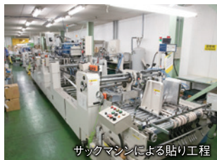
サックマシンによる貼り工程
