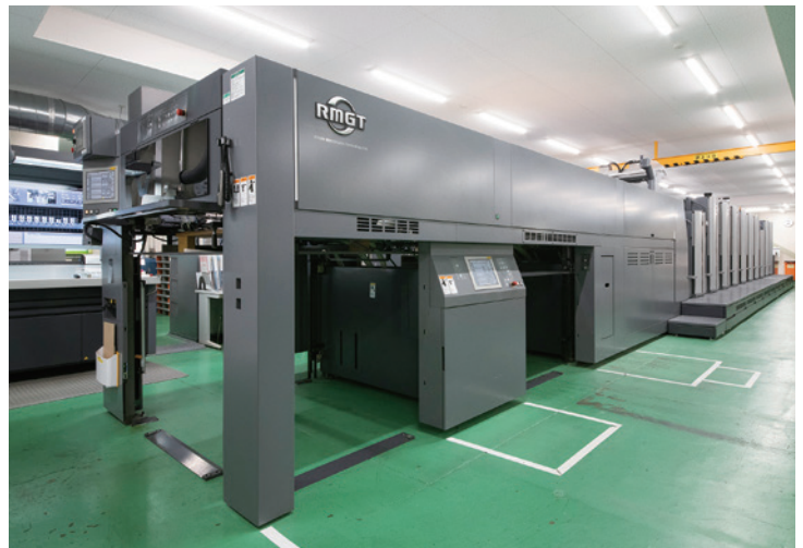
菊全判8色機 RMGT 1020V1LX-8 (コーティングユニット、品質検査装置、2連デリバリー搭載)
