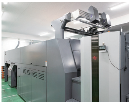
品質検査装置と 2 連デリバリーを組み合わせて品質を担保する。
