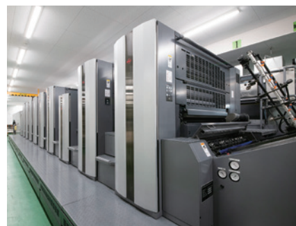
2色印刷のプリキュア性能向上へUV乾燥ユニットを搭載
